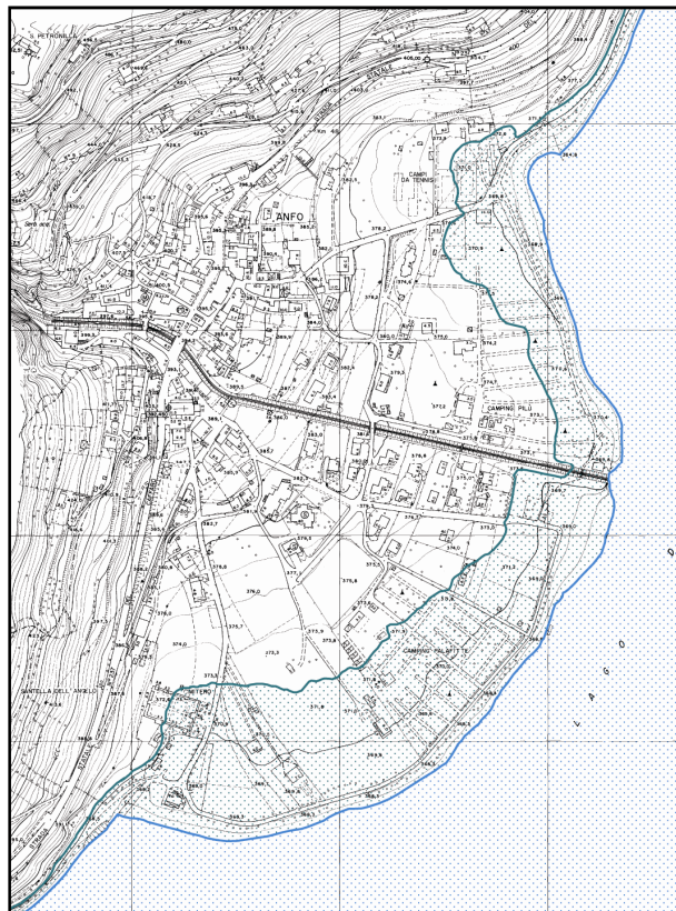
Figura 19 - Particolare aree allagate a quota 372 m s.l.m. del comune di Anfo
